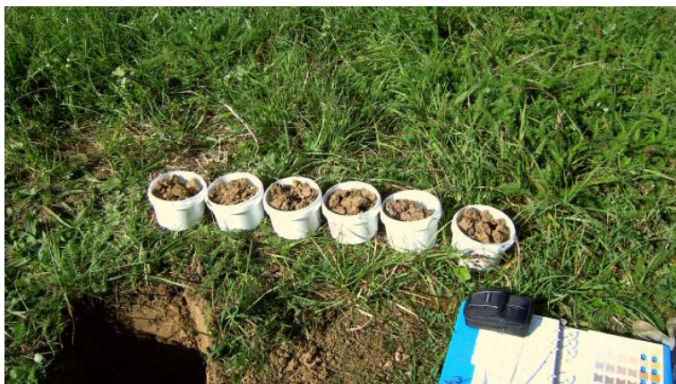
Abbildung 5-1: Bodenproben aus 5 cm Schichten des insgesamt 30 cm Tiefenprofils, Probenreihe FG Boden NO.
